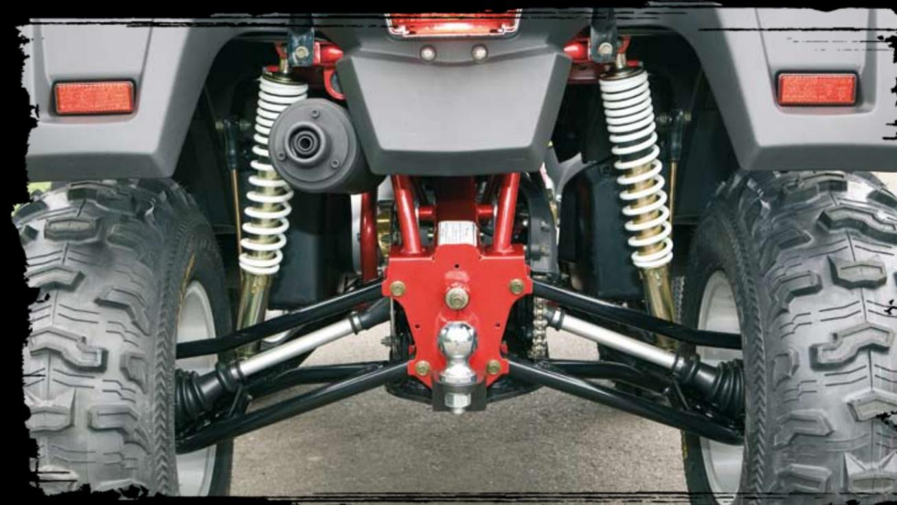
EINZELRADAUFHÄNGUNG INKLUSIVE QUERSTABILISATOR
