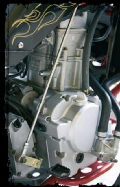
EINZYLINDERMOTOR MIT CVT-AUTOMATIK
